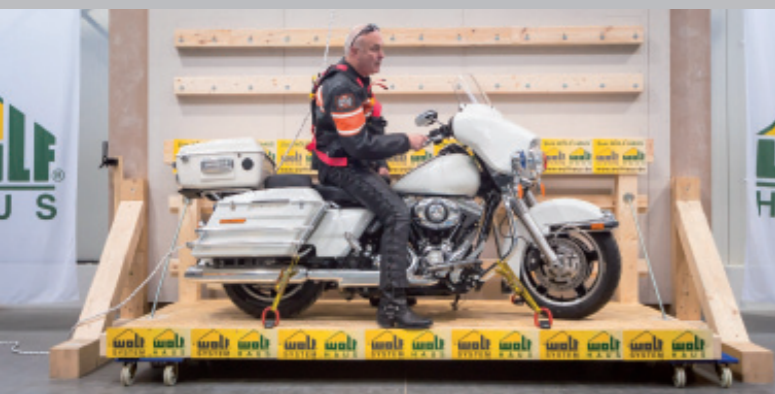
Bereit zum Test! Mensch und Maschine sind fest verankert. Jetzt muss die Wand ihre Tragkraft beweisen.
