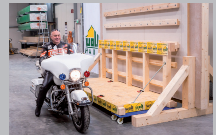
Die Holzplattform für das Motorrad wiegt 150 kg, die Harley bringt es auf 411 kg und der Fahrer auf 90 kg. Bei diesem Versuch wird die Wand also mit 651 Kilogramm belastet. So viel Gewicht kommen auch bei einem randvollen Küchenschrank niemals zusammen.
