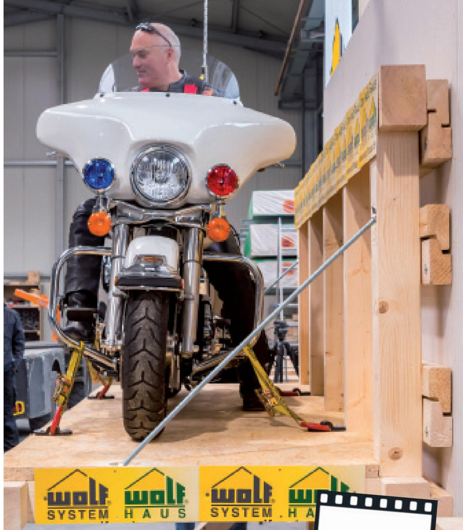
**Geklappt!** Nicht mehr als die übliche Aufhängekonstruktion verbindet die Harley Davidson plus Fahrer mit dem Holzständerwerk, wie es in jeder Hauswand von Wolf verwendet wird. Das beachtliche Gewicht ist sicher verankert und der Beweis erbracht, dass sich kein Bauherr Sorgen um die Tragfähigkeit dieser schlanken Wandkonstruktion machen muss.
